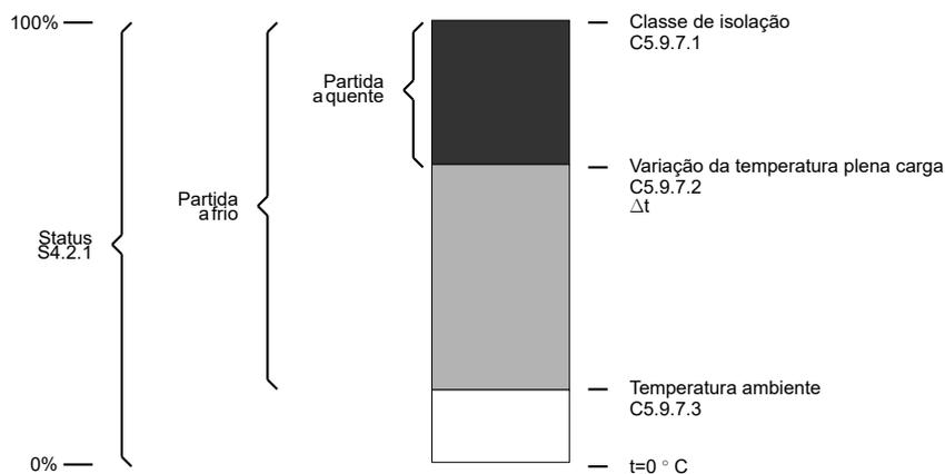
Figura 11.23: Faixas de temperaturas do motor dentro da classe de isolamento.
