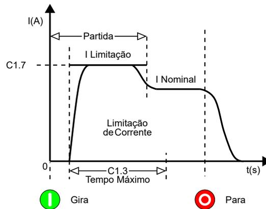
Figura 13.5: Partida com limite de corrente constante.
