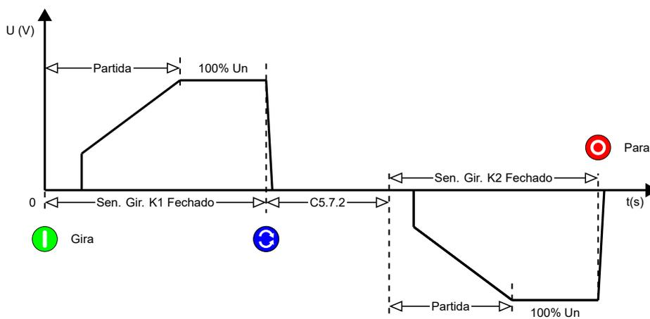
**Figura 11.28:** Troca do sentido de giro via contator.
