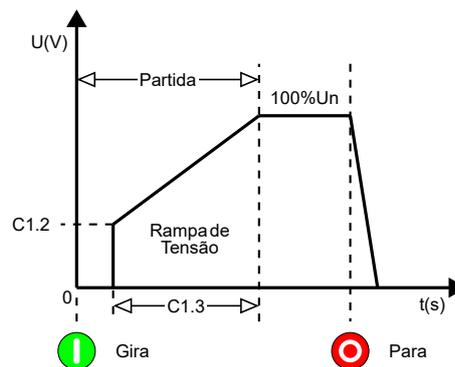
Figura 13.4: Partida com rampa de tensão.
