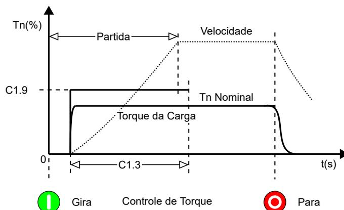
Figura 13.12: Partida com controle de torque constante, 1 ponto.
