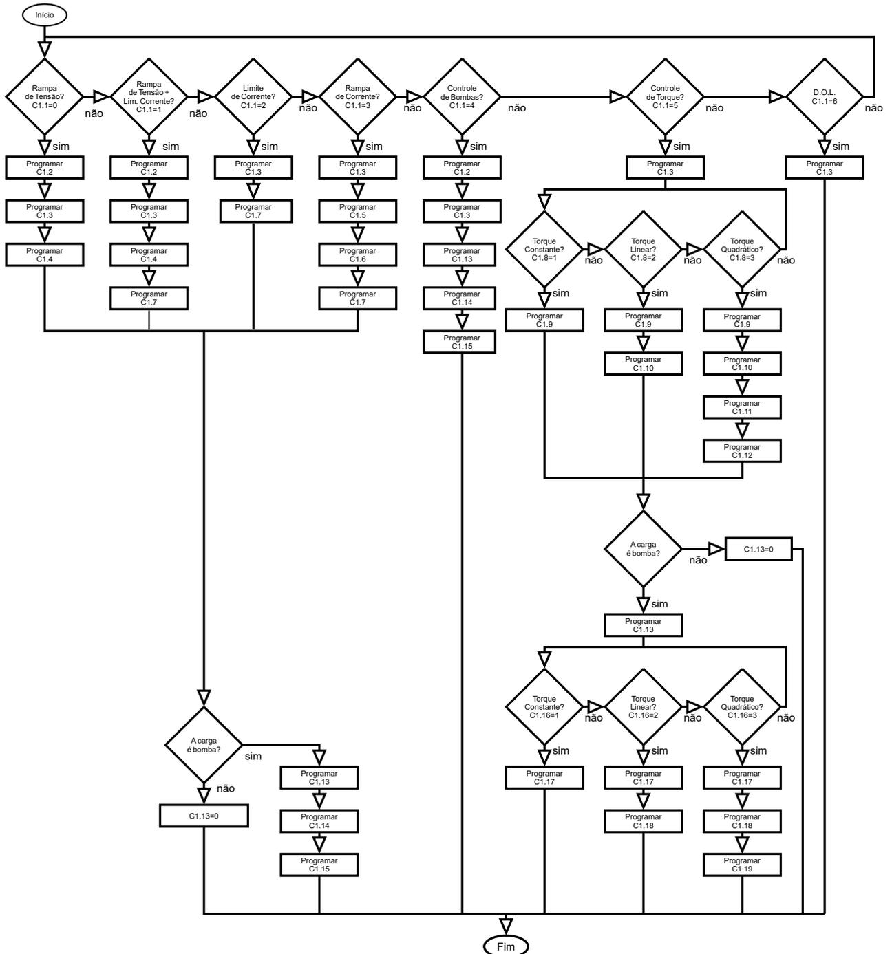
**Figura 11.1:** Sequência de programação dos tipos de controle.
