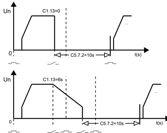
**Figura 11.18:** Aacionamento via entrada digital (DI1).
