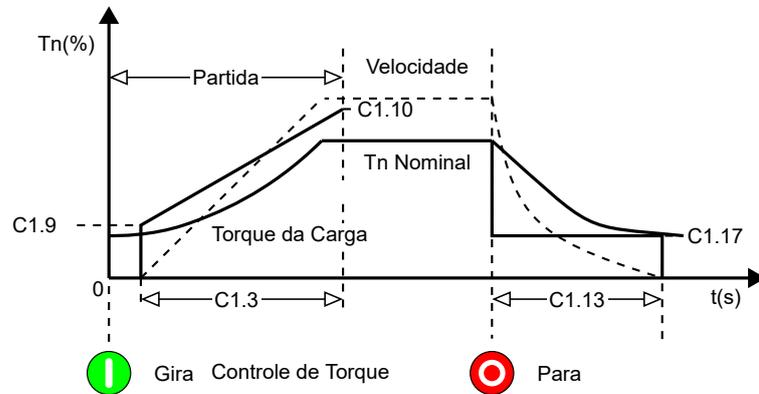
**Figura 13.20:** Bomba hidráulica parando com torque constante, 1 ponto.
