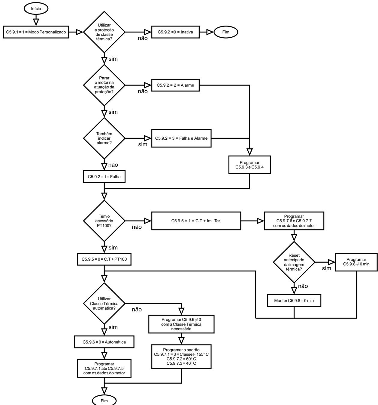
**Figura 11.21:** Sequência de programação da Proteção de Classe Térmica modo personalizado.
