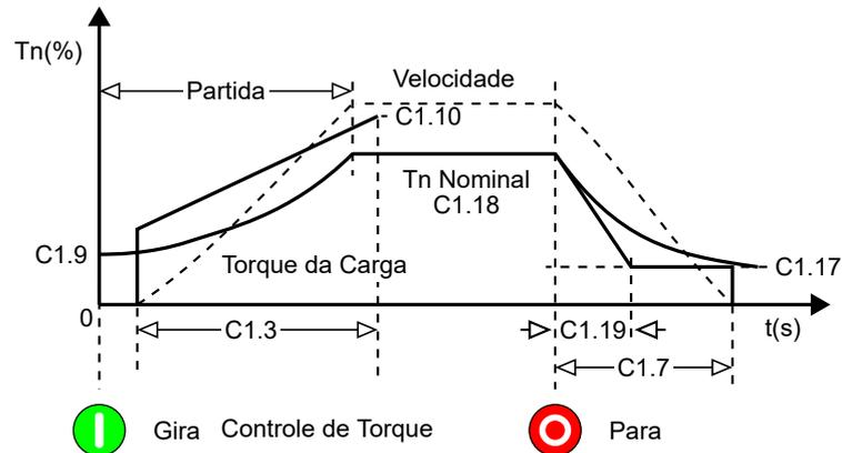
**Figura 13.22:** Bomba hidráulica parando com torque quadrático, 3 pontos.
