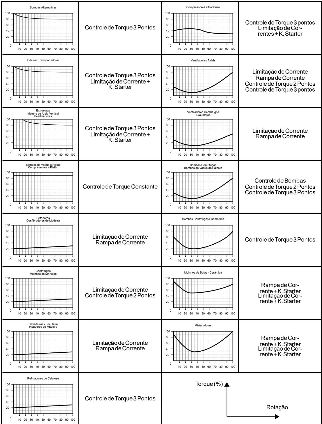
Figura 13.3: Características típicas da curva de torque de partida de alguns tipos de carga com os tipos de controles sugeridos.
