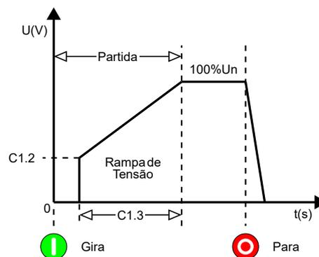
**Figura 11.3: Rampa de aceleração por Rampa de Tensão.**
