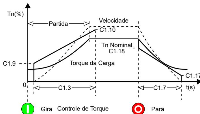
**Figura 13.21:** Bomba hidráulica parando com torque linear, 2 pontos.
