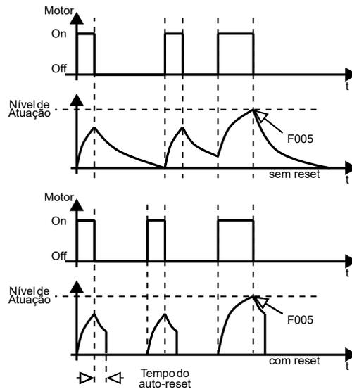
**Figura 11.27:** Reset da imagem térmica do motor.
