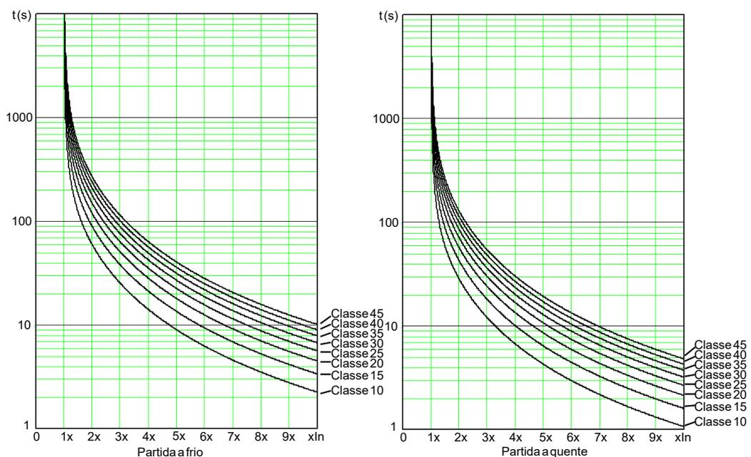
**Figura 11.22:** Classes Térmicas padrão de proteção do motor.
