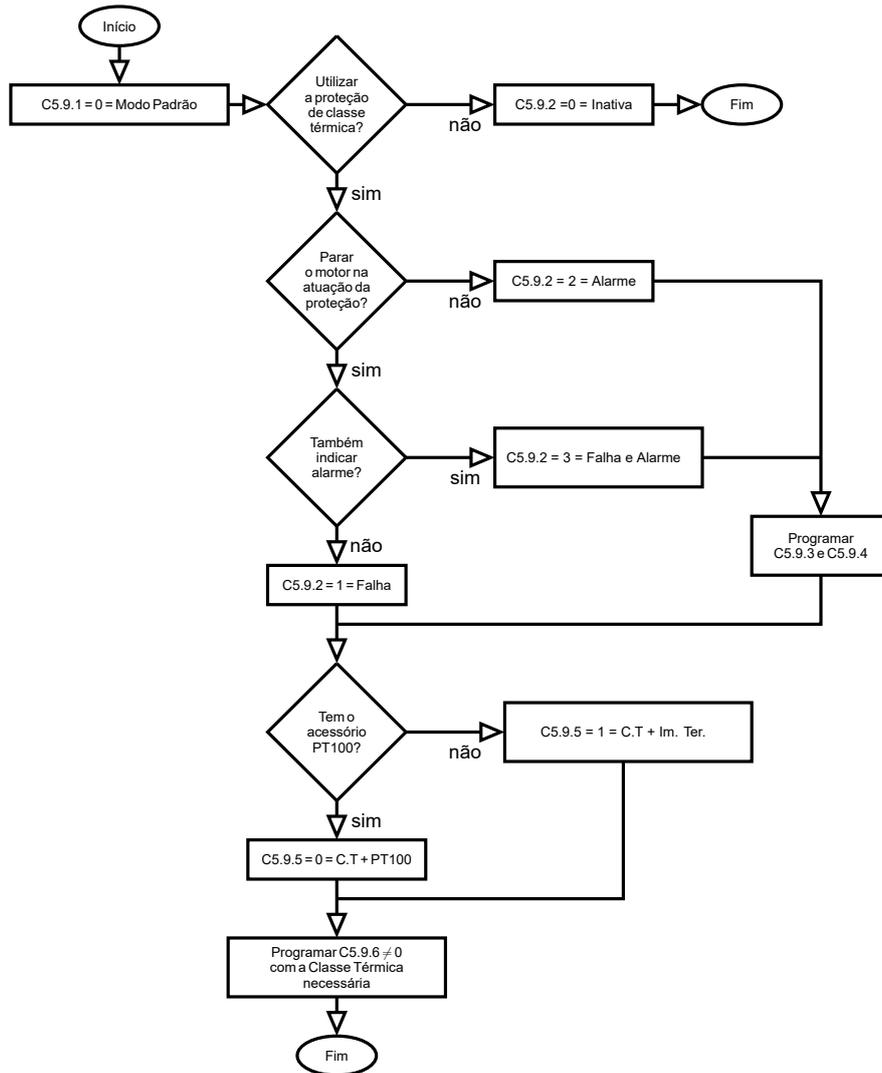
Figura 11.20: Sequência de programação da Proteção de Classe Térmica modo padrão.
