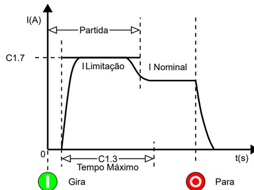
**Figura 11.4:** Rampa de aceleração por Limitação de Corrente.
