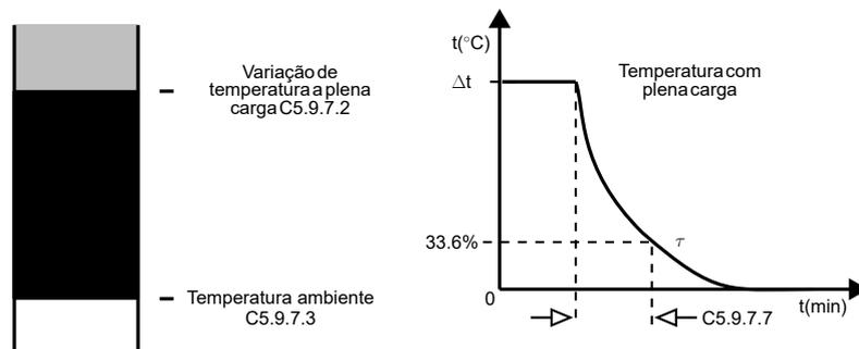
**Figura 11.26:** Constante de resfriamento do motor desenergizado.
