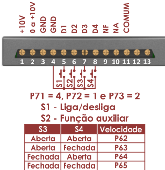
Figura 9-3 - Modos de funcionamento através dos bornes de controle
