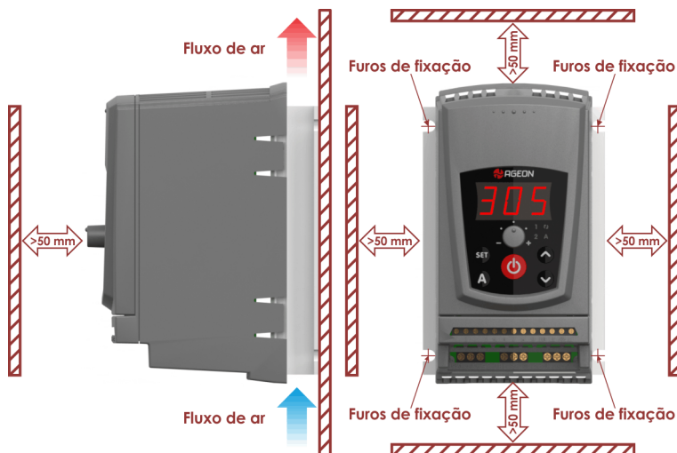
Figura 5-1 - Fixação do inversor
