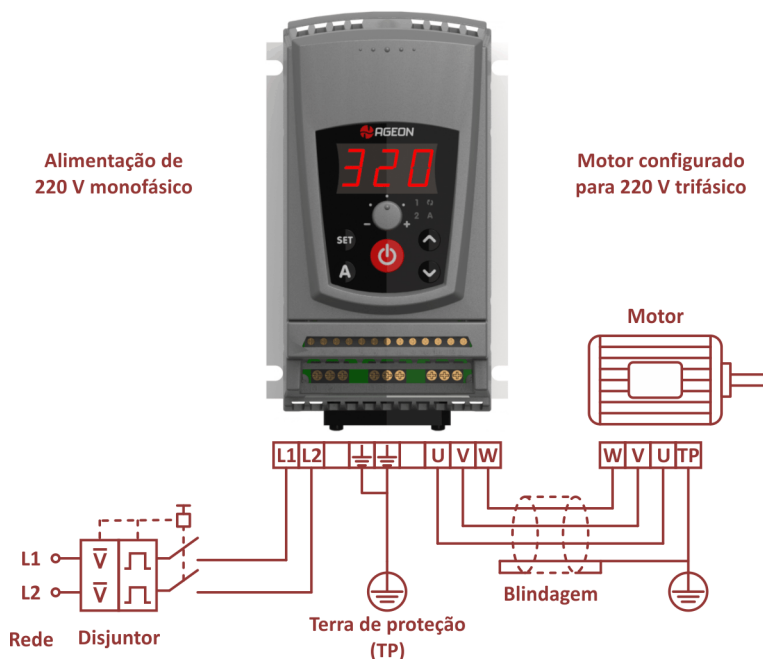
Figura 6-1 - Conexões elétricas de potência
